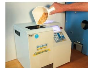
Granomat pour la détermination de la masse volumique apparente et de la teneur en humidité d'un lot de maïs
